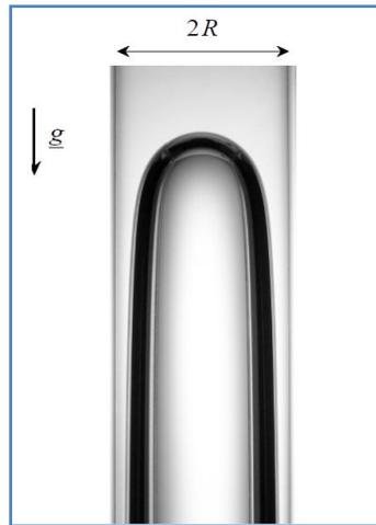
Figure 3: La bulle de Taylor dans un tube initialement rempli d'eau.
