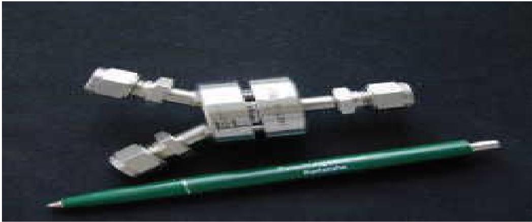
**Figure. I.3.** Micro-mélangeur de type « cyclone » développé par le FZK
