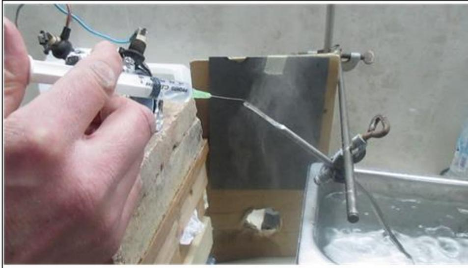
Figure.10 : aérosol développé par la technique bain ultrasons
