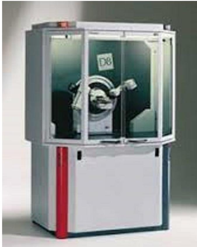
**Figure II.7:** Diffractomètre des rayons X de marque « D8 ADVANCE BRUKER »
