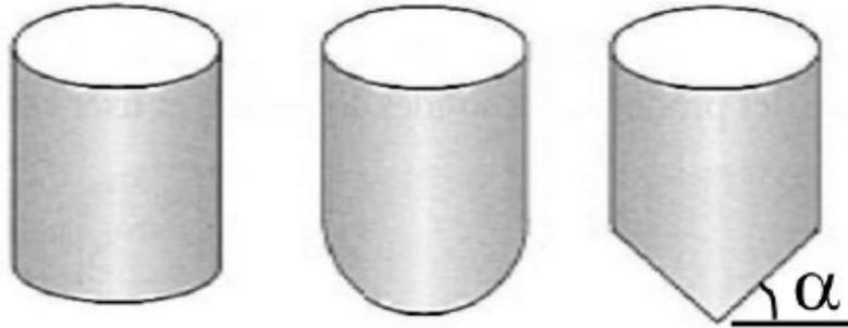
**Figure I.2** Divers fonds de cuve cylindrique ( $H \approx T$ ) [14]
