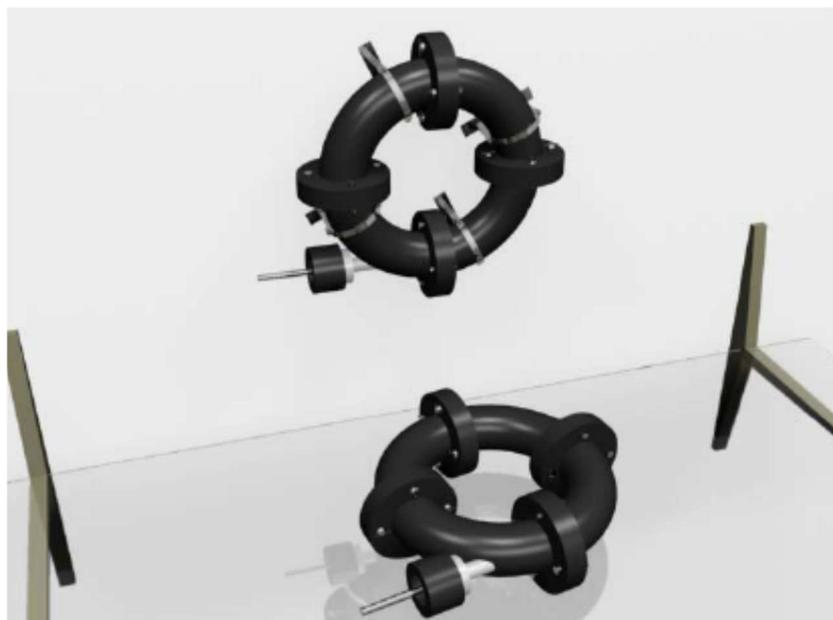
**Figure II.1 (a)** Schéma d'un Réacteur Parfaitement Torique (RPT)
