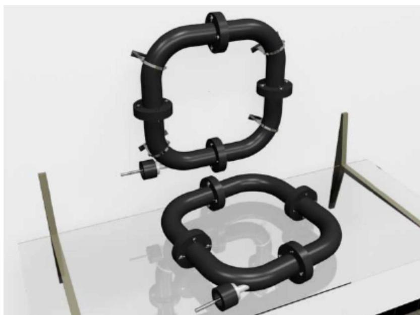
**Figure II.1(b)** Schéma d'un Réacteur Torique à Longueurs Droites (rectangulaire) (RTLTD)
