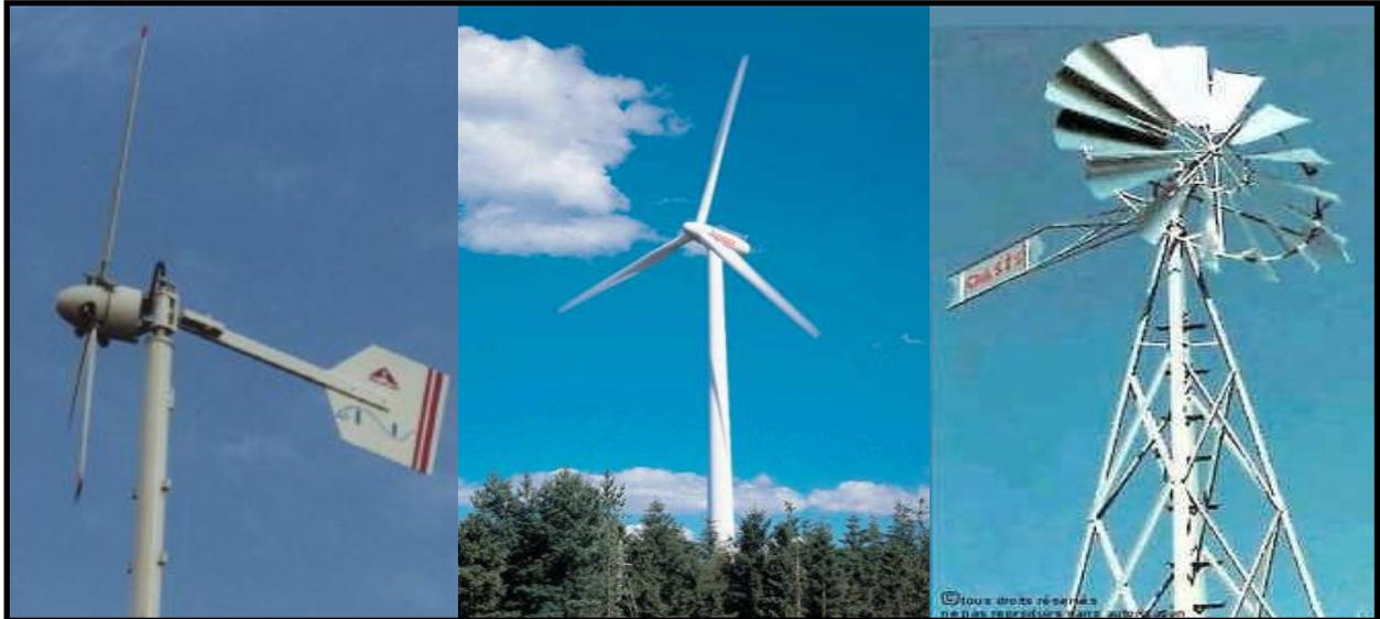
**Figure (I.10) : Eoliennes à axe horizontal [20].**
