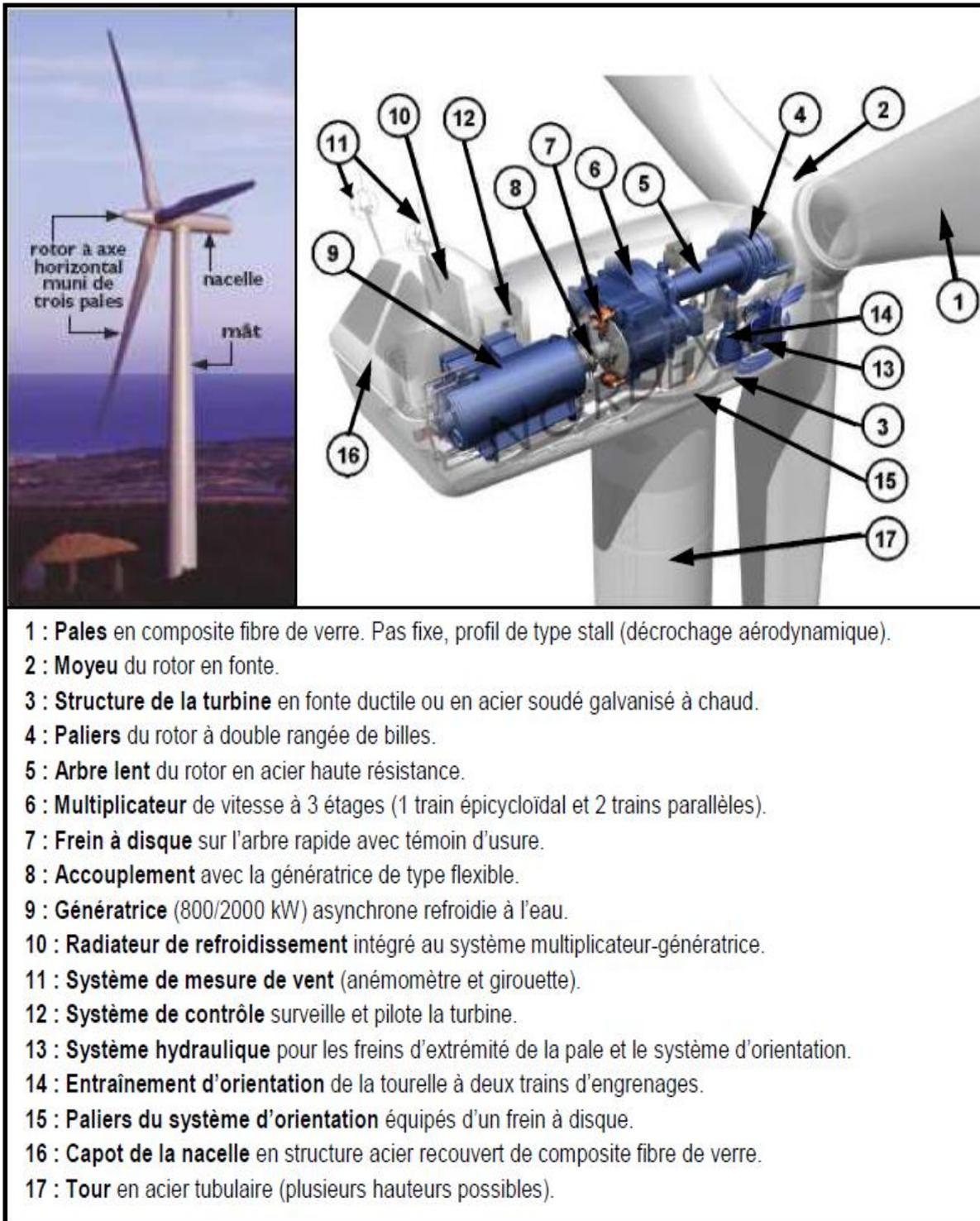
Figure (I.12) : Différents composants d'une éolienne [6]
