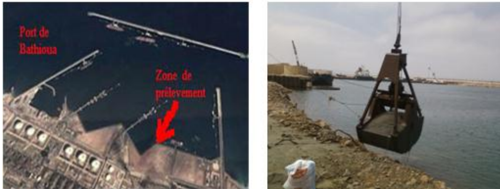
Figure IV.2: Zone d'échantillonnage des sédiments à l'aide d'une drague mécanique.
