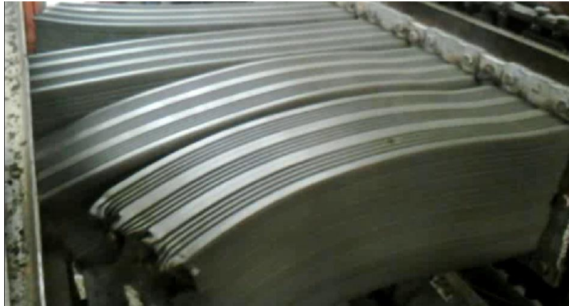
Figure IV.7: La mise en forme de la pate des briques à Hassi Ben Okba.
