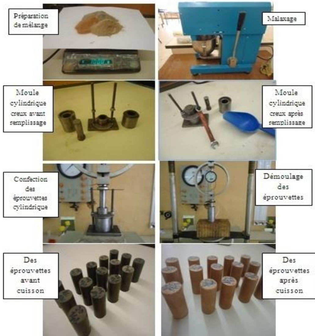
Figure VI.5: Préparation en laboratoire des éprouvettes de brique.
