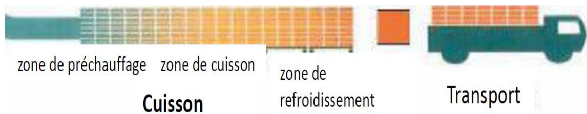
Figure IV.8: Processus de cuisson des briques à Hassi Ben Okba.
