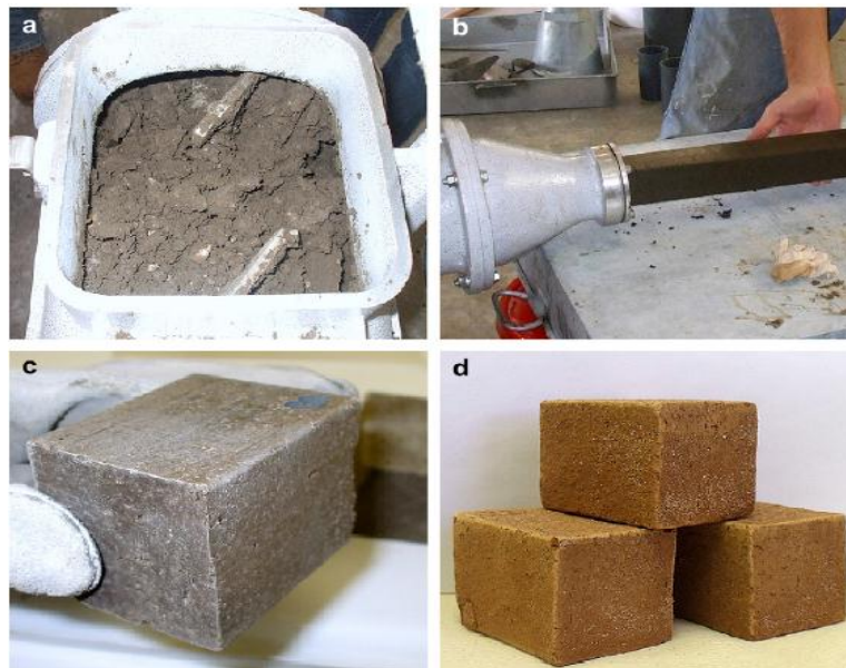
Figure III.4: Production de briques à l'échelle de laboratoire: a) mélange des matières premières, b) extrusion d'une colonne de briques, c) brique séchée, d) briques cuites.
