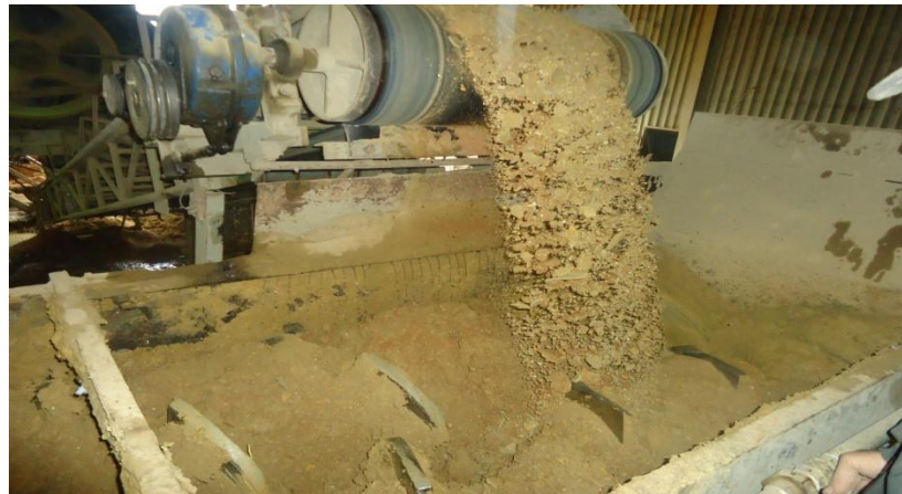
Figure IV.6: Préparation de la pâte des briques à Hassi Ben Okba.
