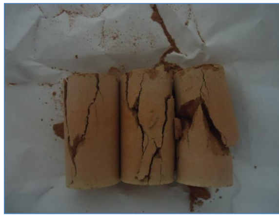
Figure VI.7: Echantillons de brique après le test de compression.
