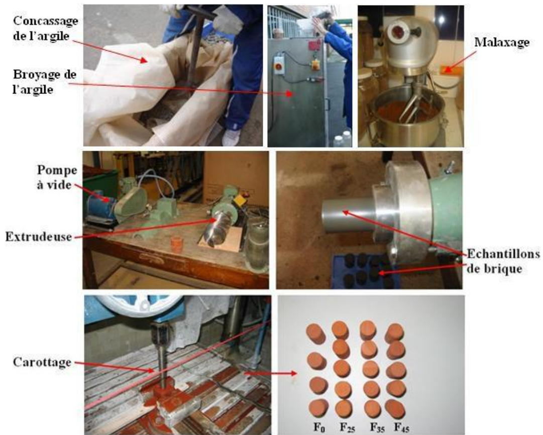
Figure III.2: Préparation en laboratoire des échantillons de brique.
