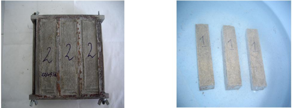
Figure III.11: Eprouvettes de mortier à base de sédiments.
