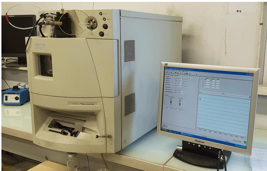
**Fig. II. 5.** Spectromètre de masse basse résolution (GC/MSn)
