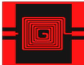
Figure IV.6 : Définition de la spirale plus le plan de masse
