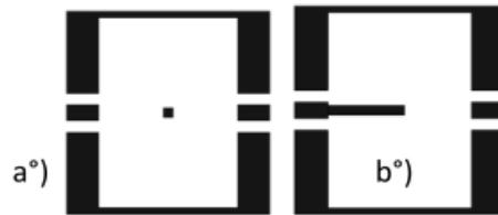
**Figure IV.10 :** Masque pour via ; a) coffrage pour plot, b) via horizontal
