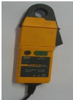
Ces deux capteurs ont pour rôle de donner une image du courant statorique par effet de Hall. Le courant maximal pouvant être mesuré est de 20A, le rapport de conversion est de 100mV/A.
