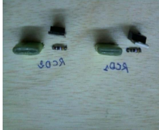
Figure. II.2.14 : Circuit RCD contre le court-circuit.
