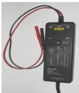
Ces deux capteurs ont pour rôle de mesurer les tensions de phases. Ils mesurent la tension instantanée et possèdent les caractéristiques suivantes: Tension maximale variant de -1000V à +1000V, rapport de conversion (1/50) ou (1/500) selon le choix du manipulateur.
