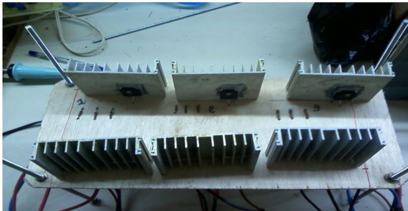
Figure. II.2.15 : Circuit de puissance d'un onduleur à deux niveaux.
