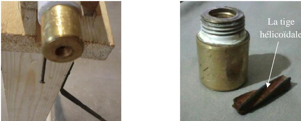
*Figure III.2* : Buse utilisée dans le travail expérimental.
