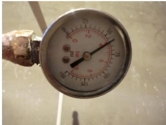
**Figure III.8 :** Le manomètre.
