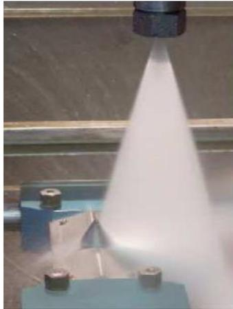
*Figure I.6* : Instrument de mesure de la force d'impact [19].
