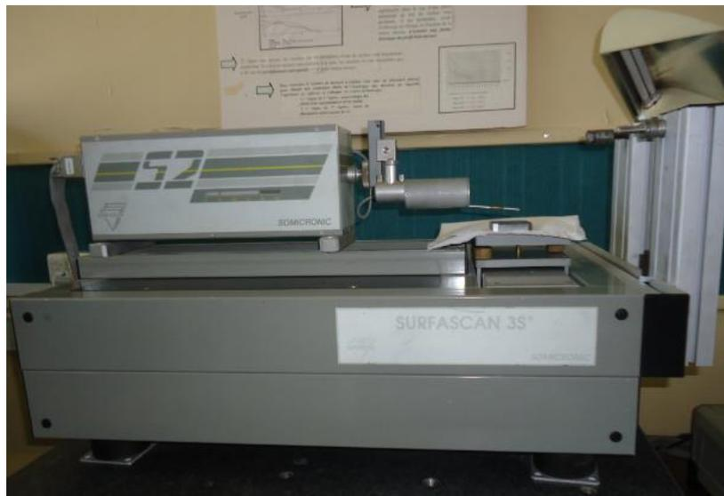
**Figure 4.6 :** Profilomètre - SURFASCAN 3S
