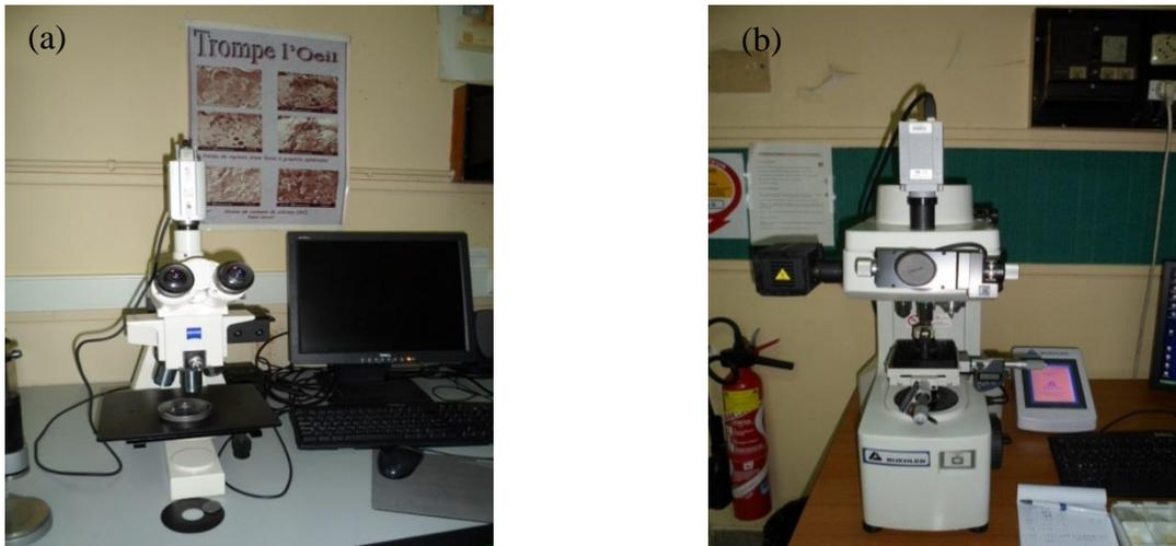
Figure 4.8 : (a) Microscope optique, (b) Microduromètre
