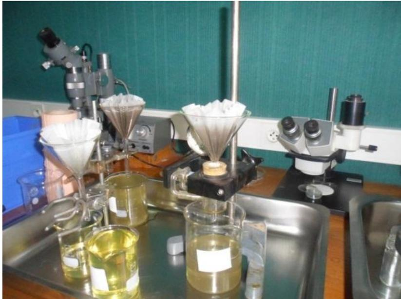
**Figure 4.7 :** Procédure du filtrage d'huile
