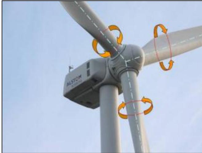
*Fig. I. 21: L'éolienne à vitesse de rotation variable par à variation de l'angle de calage.*
