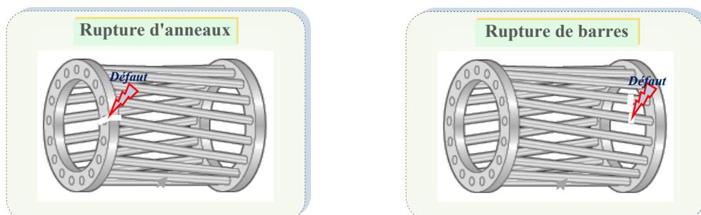
Figure 1.12 : Défaut de rupture de barres et d'anneau de court-circuit
