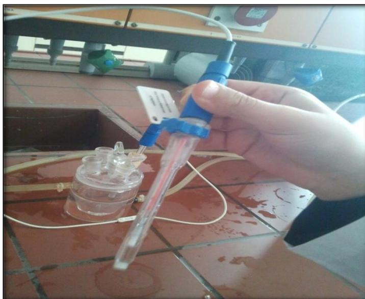
**Figure II.3 :** Electrode de référence à base calomel saturé (ECS : Hg /Hg<sub>2</sub>Cl<sub>2</sub> /KCL).
