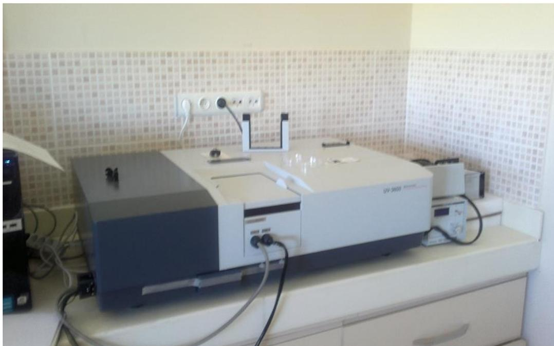
**Figure III.16** : Spectrophotomètre type UV-1800 de marque SHIMADZU.
