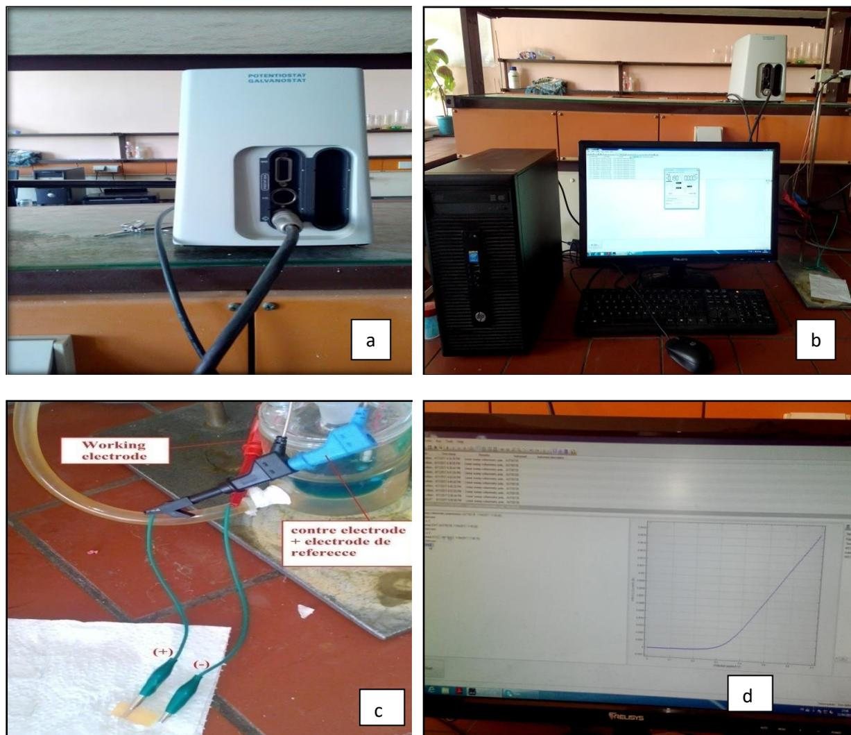
**Figure II.17 :** Montage électrochimique de mesure caractérisation courant-tension a l'obscurité ( a : Autolab, b : Micro-ordinateur, c : Les fils de cathode (+) et anode (-), d : La courbe courant-tension I-V.
