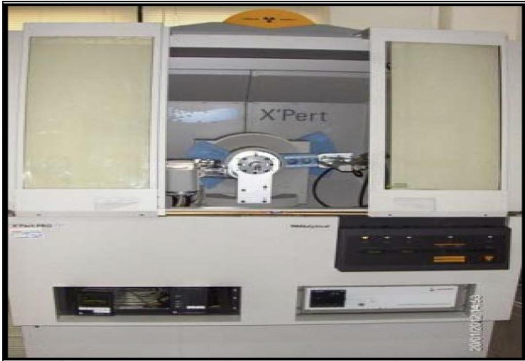
Figure II.12 : diffractomètre de rayons X de type Philips PANalytical Xpert Pro (PANalytical B.V., Almelo, The Netherlands).
