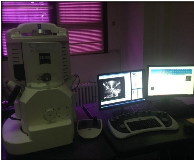
Figure III.13 : Photo de microscope électronique à balayage de type Zeiss EVO LS 10
