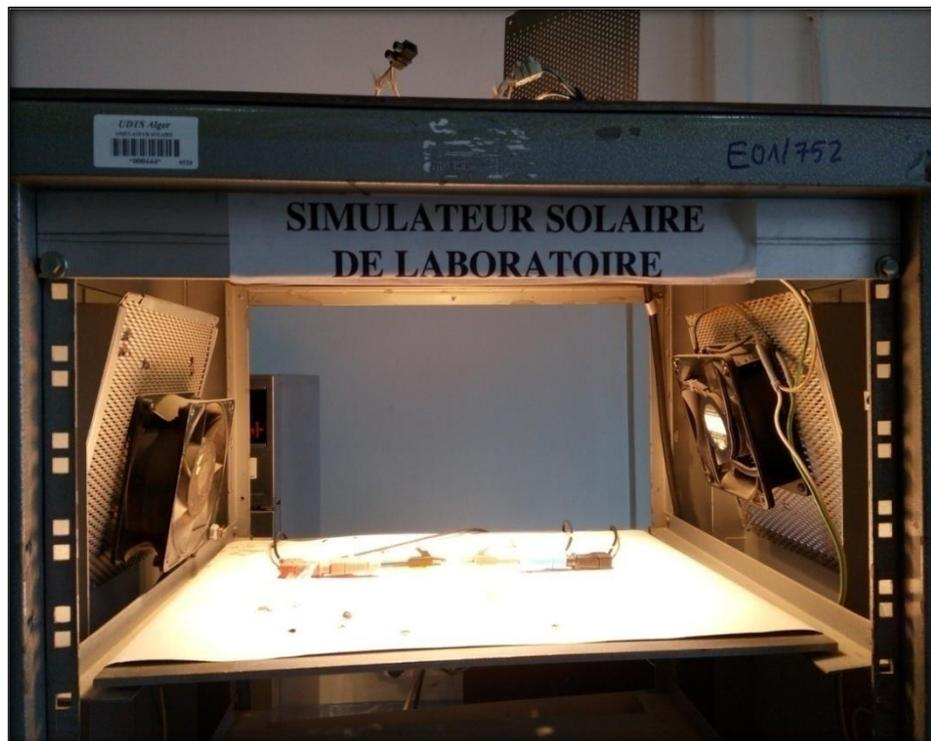
**Figure IV.35 b :** Dispositif de mesure et simulateur solaire d'une cellule solaire  $\text{Au}/\text{Cu}_2\text{O}/\text{ZnO}/\text{ITO}$  sous éclairage (Centre CRTSE-Alger).
