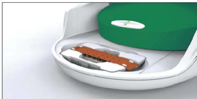
Figure 32 : Photo d'une cassette DG8 placée dans le générateur de droplets QX200.
