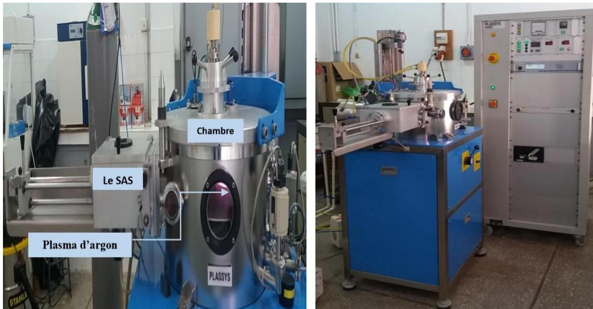
Figure 2.5 : Appareillage de la pulvérisation cathodique magnétron RF du laboratoire LPCMME.
