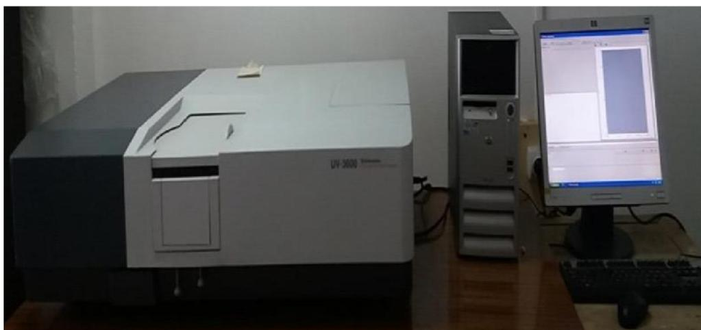
Figure 2.6 : Spectrophotomètre CHIMADZU UV3600 du Laboratoire LPCMME.
