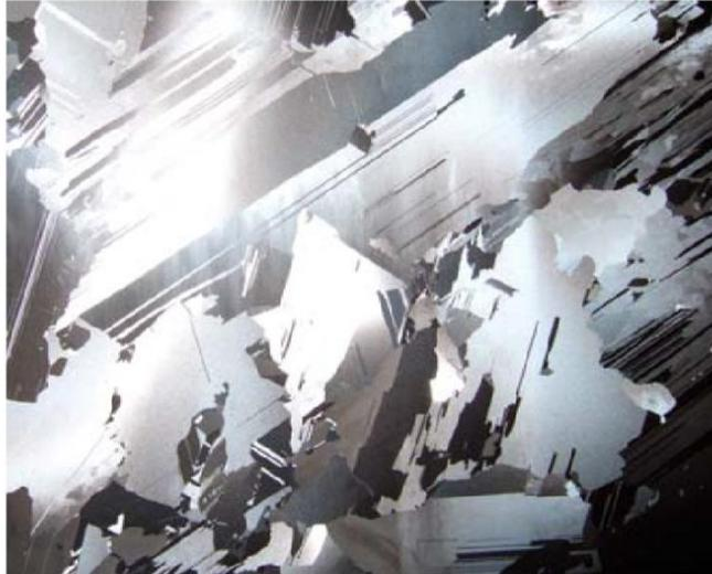
Figure 3.2 : Photo d'un substrat de silicium multicristallin (échelle :  $10 \times 10 \text{ cm}^2$ ) [2].
