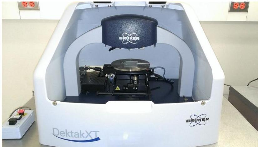
**Figure III-10: Photo du profilomètre Bruker utilise pour la mesure de l'épaisseur**
