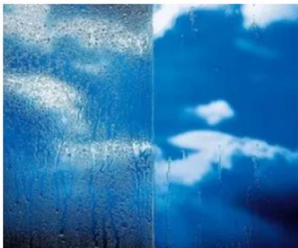
**Figure I-15: Photo comparative d'une vitre simple et d'une autre dotée d'un revêtement autonettoyant [65].**
