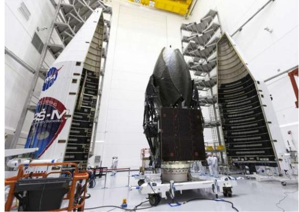
(c) Antennes déployables de la mission "TDRS-M" de la NASA
