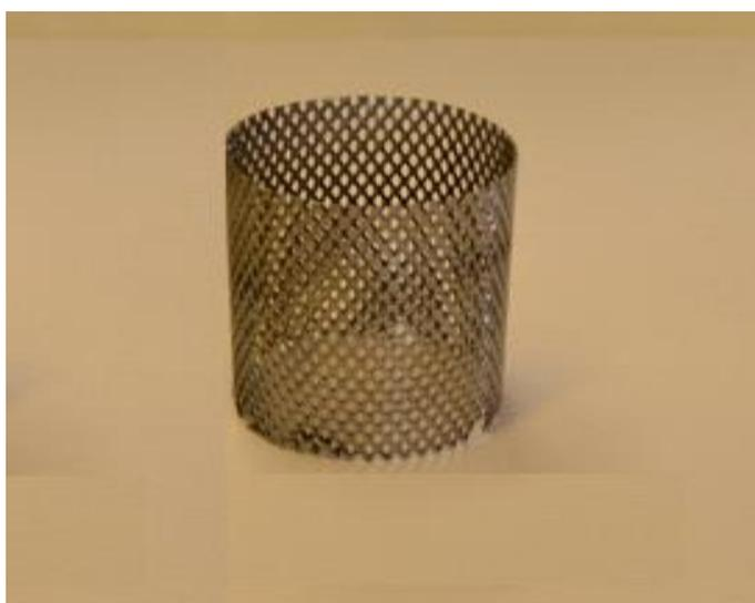
**Figure II-5:** Contre-électrode en acier inoxydable en de maille cylindrique utilisée avec L'électrode textile
