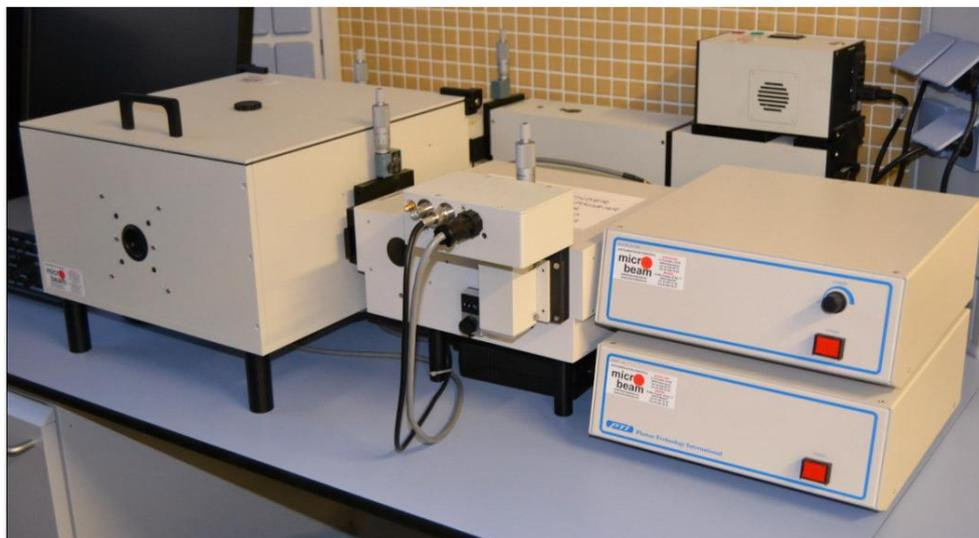
Figure II-12: Image du spectrofluorimètre utilisé dans ce travail
