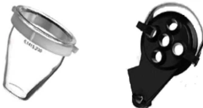
**Figure II-4:** Cellule électrochimique forme conique
