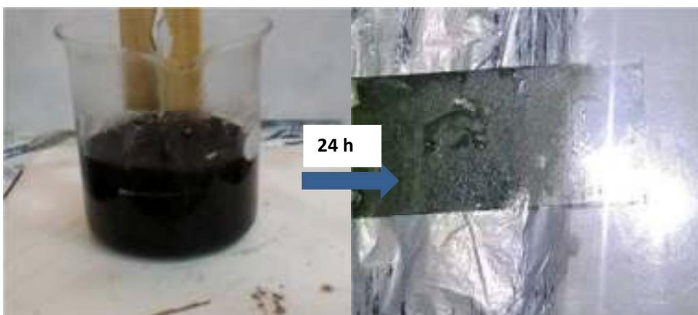
*Figure III.4: Procédure du dépôt de CZTS (1) par bain chimique*
