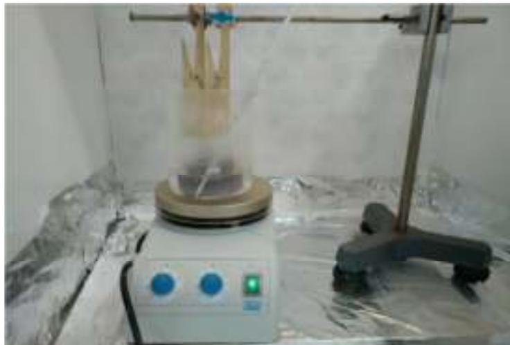
*Figure III.2 : Technique exp rimentale CBD au sein de LMESM.*
