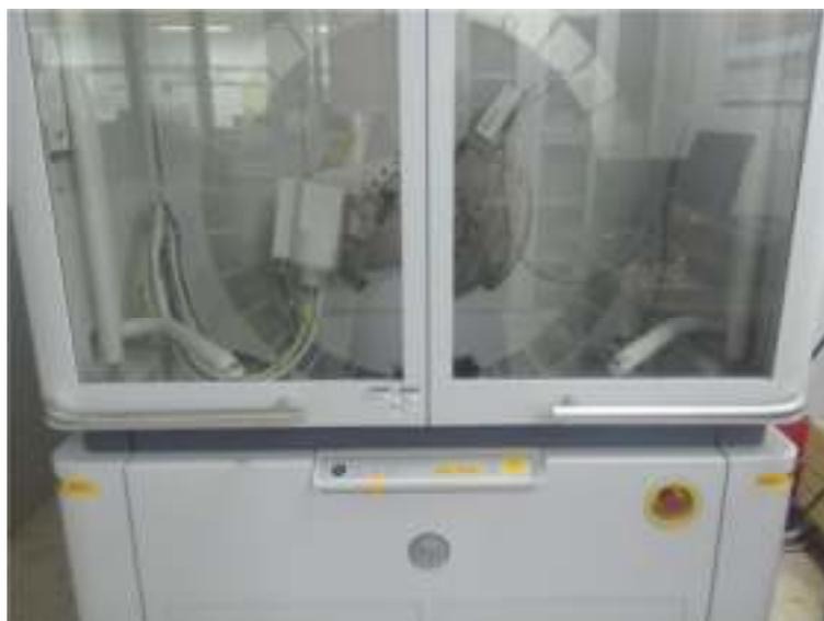
*Figure III. 10. Le diffractomètre à haute résolution (Panalytical) DY 1352)*
