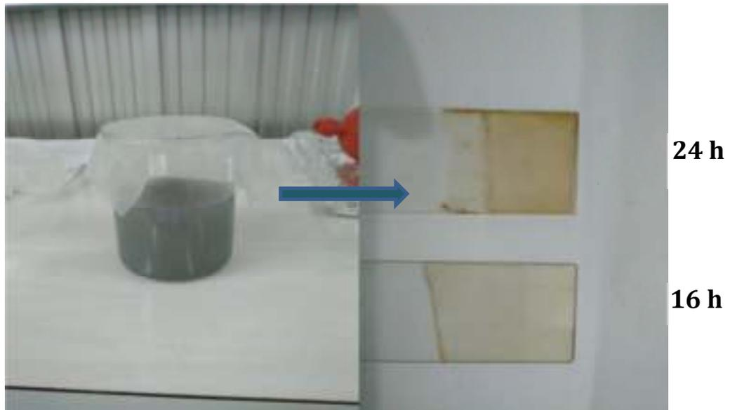
**Figure III.5** : Procédure du dépôt de CZTS (2) par bain chimique
