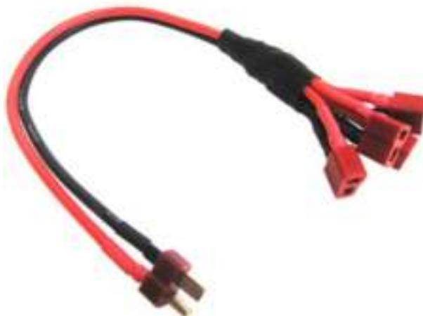
FIGURE 3.12 – L’harnais de distribution d’énergie.
