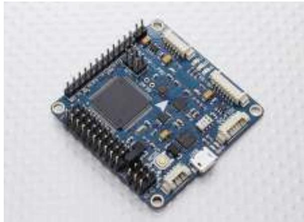
FIGURE 3.15 – La carte de control MULTIWII à base d'Arduino.
