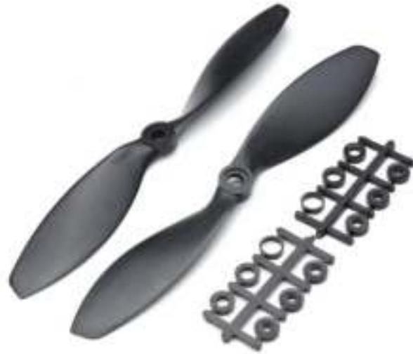
FIGURE 3.8 – Les Hélices au sens horaire et anti-horaire.
