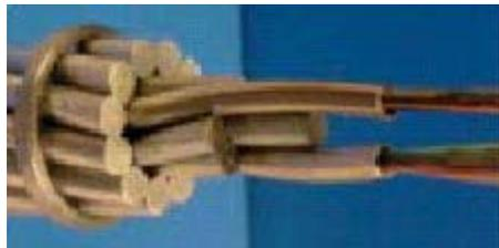
Figure. I.7 : photo d'une fibre optique insérée dans un câble de garde
