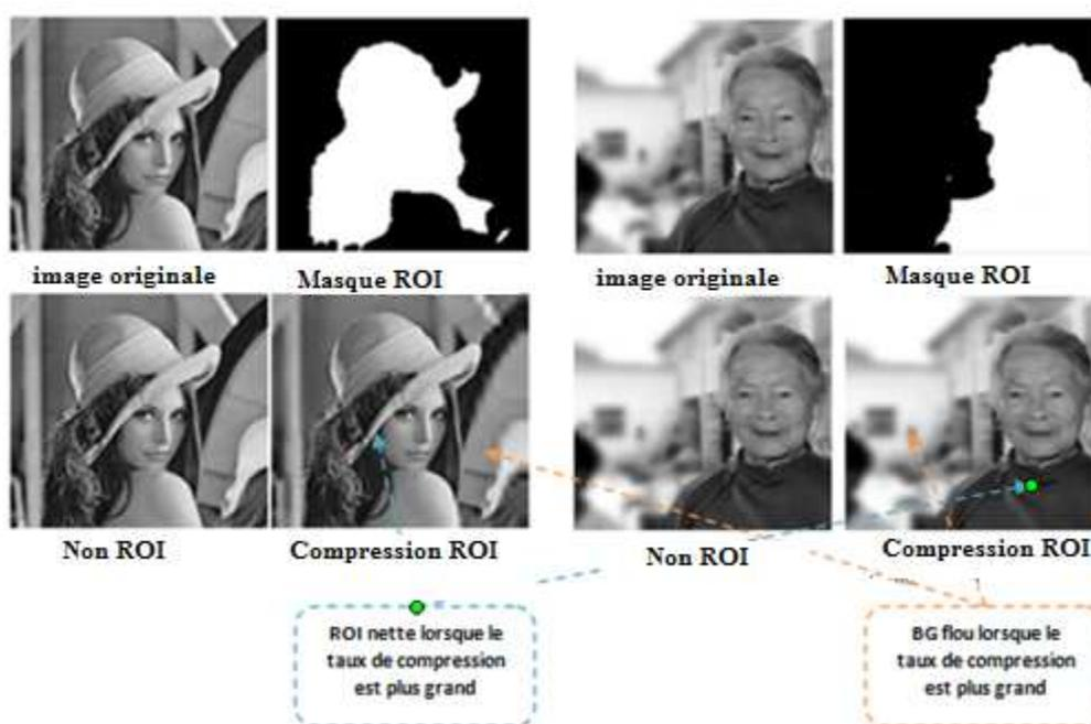
Figure III.14. Résultats de compression par l'algorithme basé sur l'extraction automatique de ROI [70]
