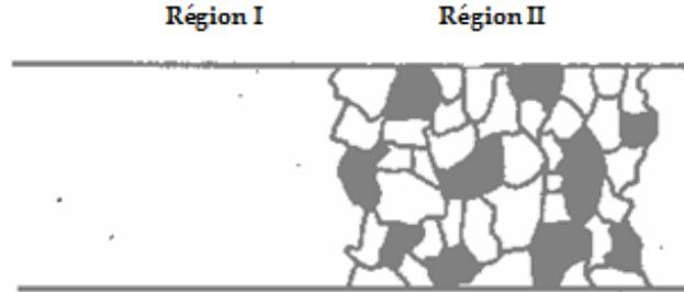
Figure (II-2) : Milieu Homogène (I) et biphasique (II).
