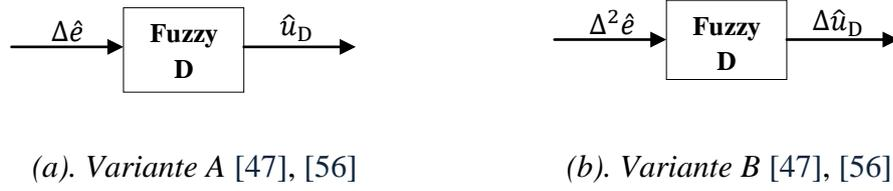
Figure (2-7) : Contrôleurs flous de type dérivé: FD. (a). Variante A : FD avec une sortie absolue.
