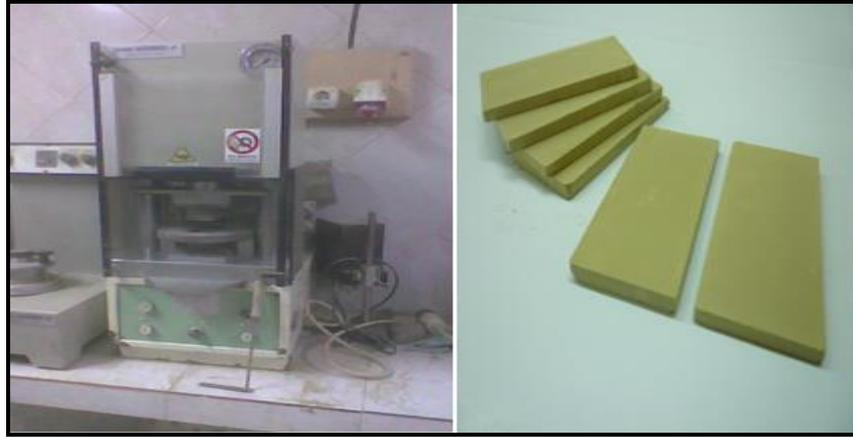
**Photo (VII.2) :** Carreaux éprouvette préparés par une presse hydraulique
