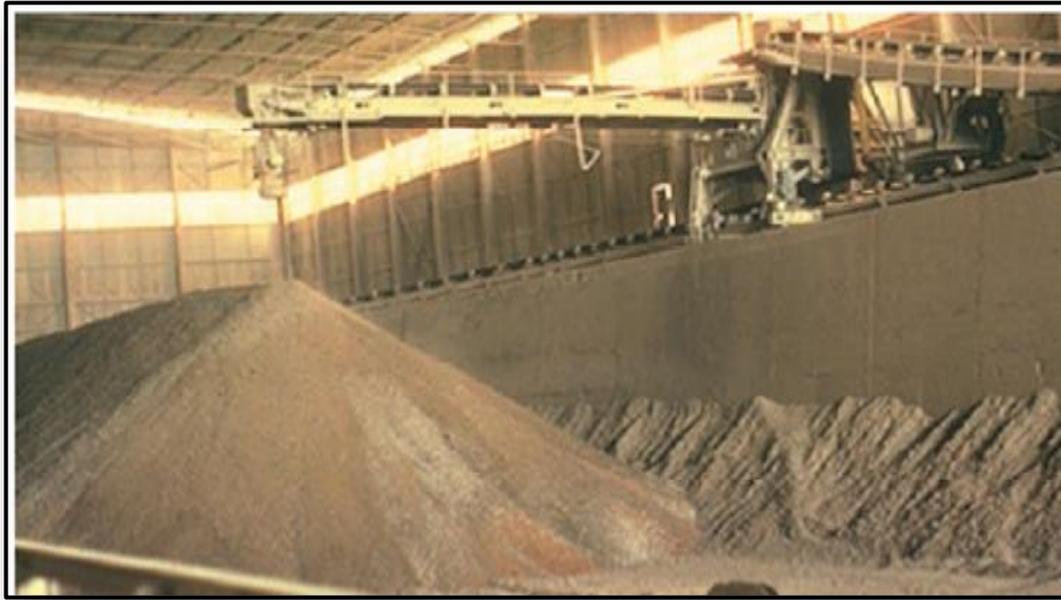
**Photo (IV.4) :** La pré-homogénéisation
