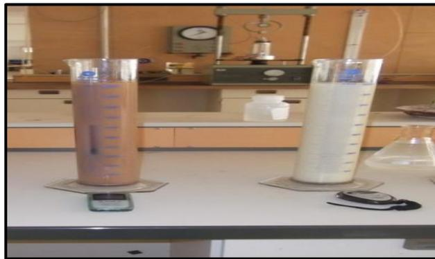
**Photo (VI.7) :** Les mesures de sédimentation à différent temps
