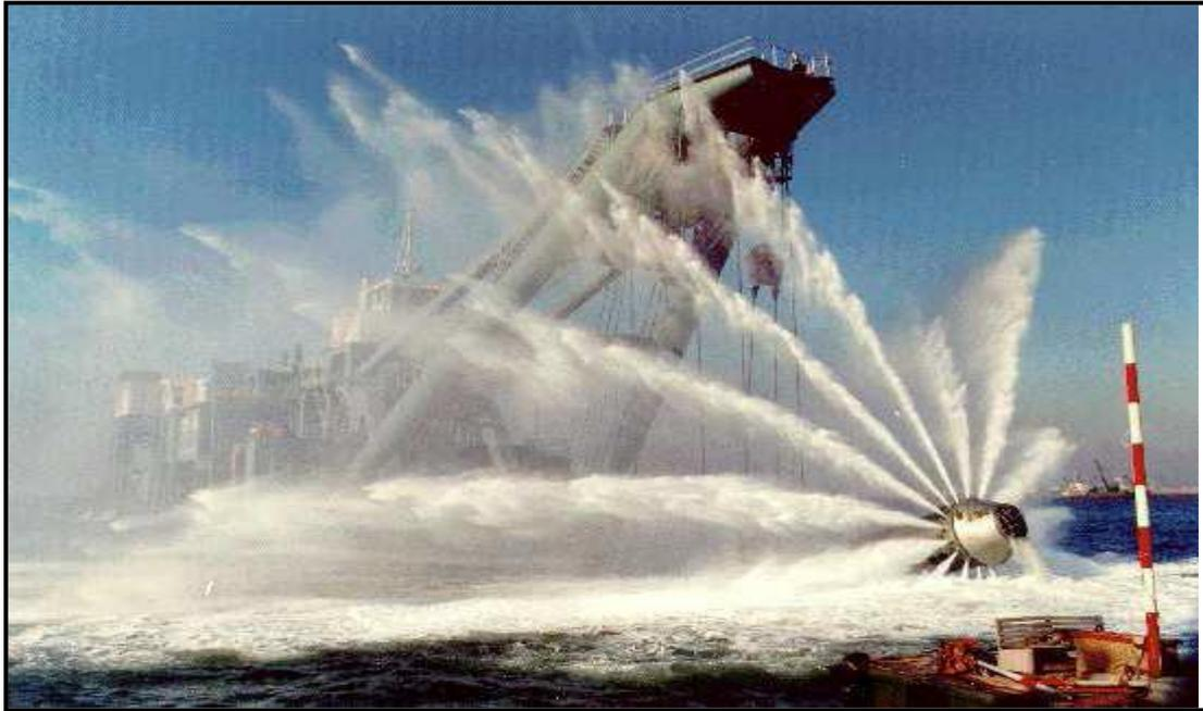
**Photo (II.9) :** Tête de succion et dispositif de déstructuration par injection d'eau
