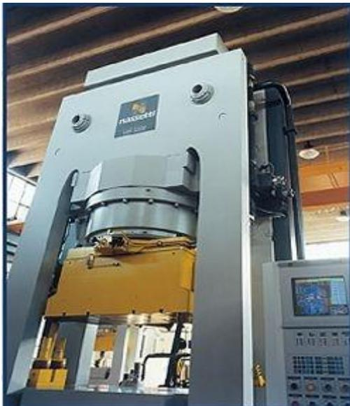
La poudre obtenue lors de l'atomisation et injectée dans un moule qui lui donnera le format désiré. A l'intérieur du moule la presse agit avec une charge qui peut aller jusqu'à 5000 tonnes.
