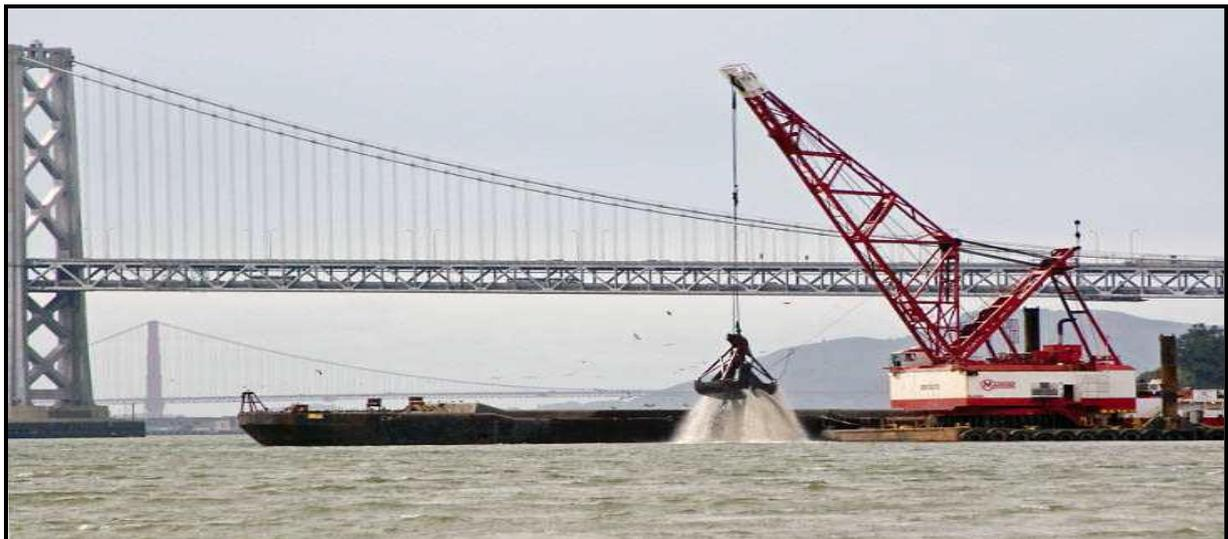
**Photo (II.6) :** Modes de préhension des sédiments à l'aide de bennes preneuses
