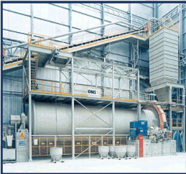
Le mélange de matière première passe dans un broyeur qui réduira en pâte humide (barbotine) de grains plus ou moins fins en fonction du type de produit le mélange de terre et de matière première.
