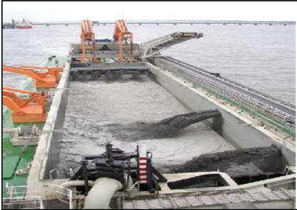
**Photo (II.8) :** Puits et conduites de refoulement d'une DAM
