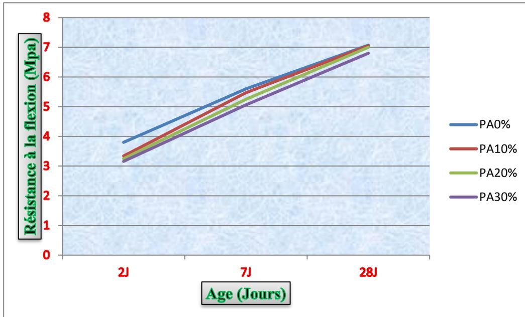
**Figure (VIII.10) :** Résistance mécanique à la flexion des différents mortiers préparés en fonction de l'âge de conservation
