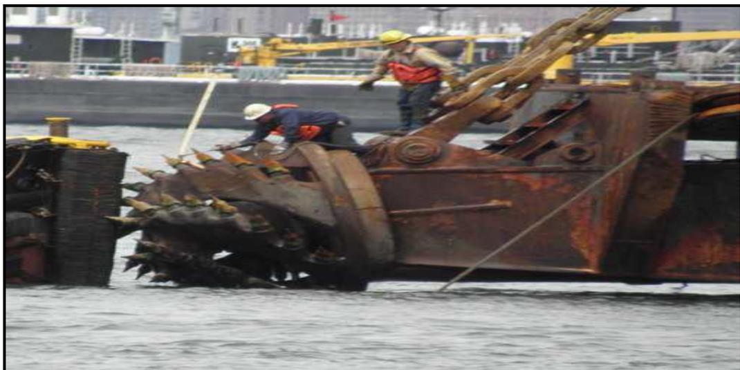
**Photo (II.10) :** Modèle de disque désagrégateur
