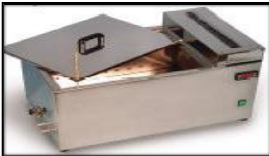
Photo (VIII.9) : Mortiers dans une armoire d'eau
