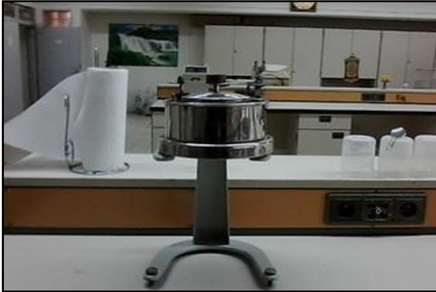
**Photo (VI.16) :** Viscosimètre Engler
