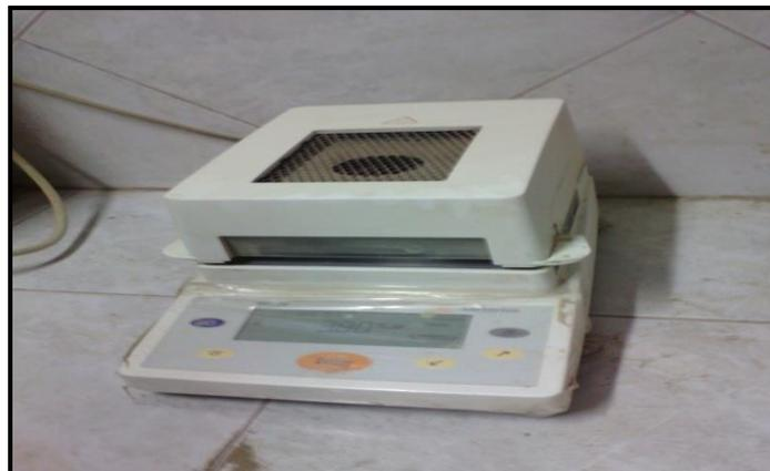
**Photo (VII.6):** La balance thermique
