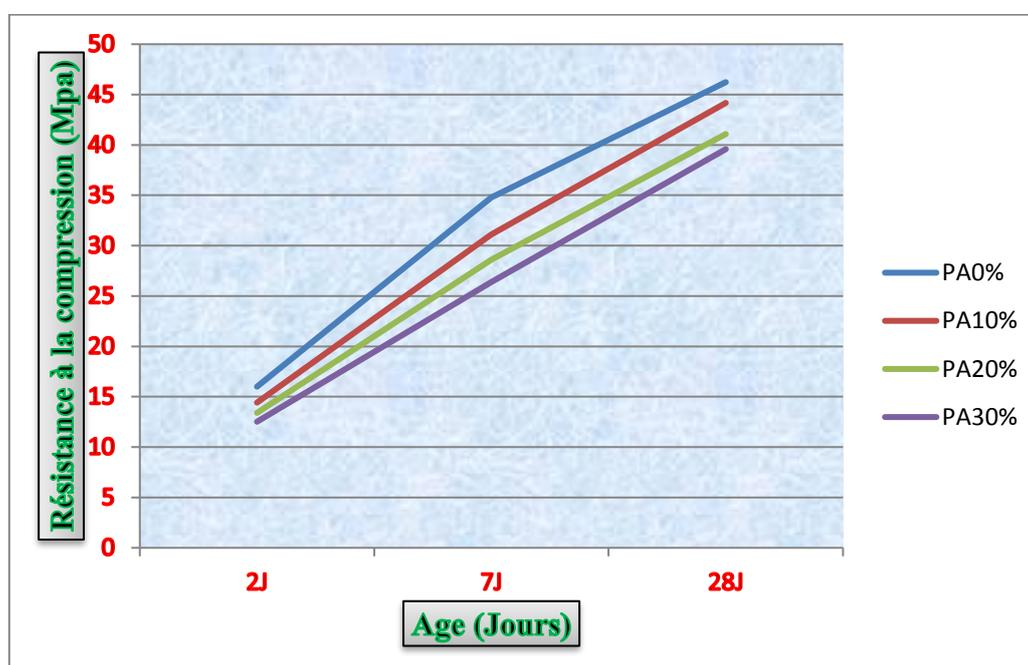
**Figure (VIII.12) :** Résistance mécanique à la compression des différents mortiers préparés en fonction de l'âge de conservation
