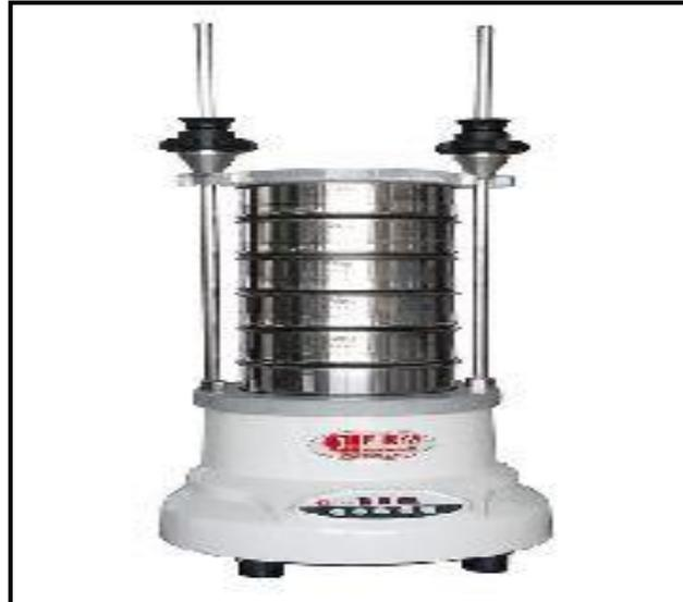
**Photo (VII.7) :** Tamis superposés dans le vibreur
