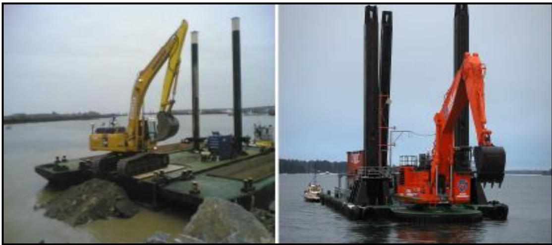
**Photo (II.5) : Pelle sur pontons et dipper dredger**
