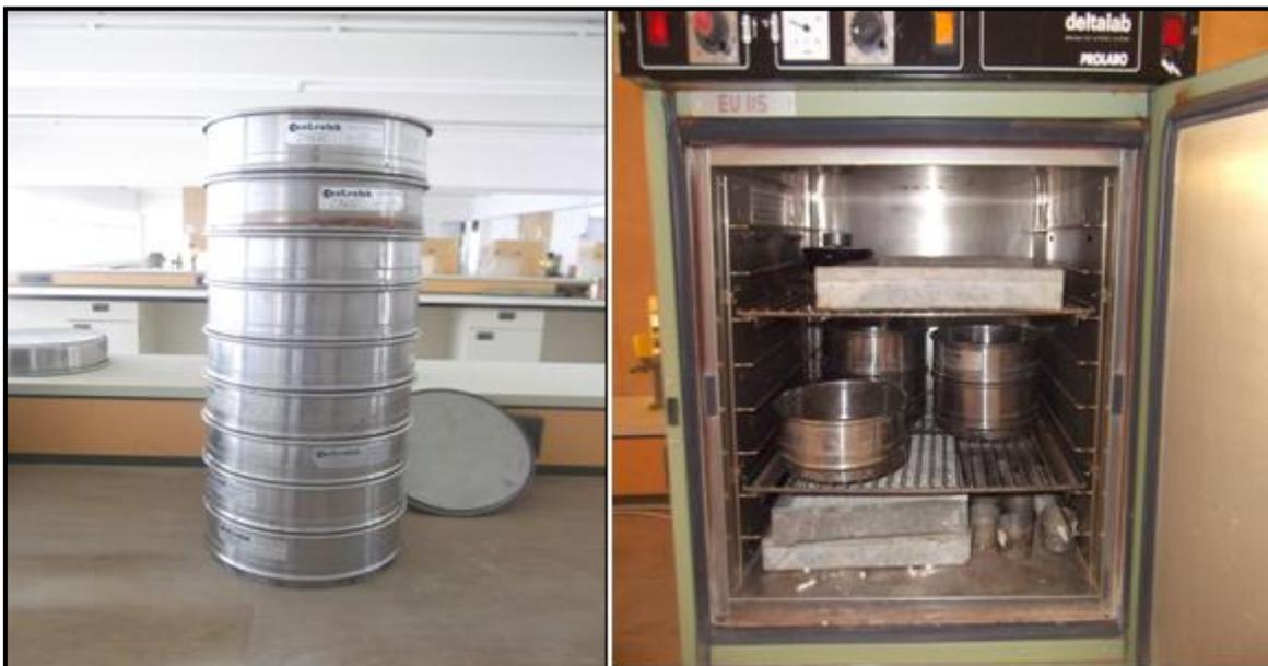
**Photo (VI.3) :** Les tamis dans l'ordre décroissant **Photo (VI.4) :** Les tamis dans l'étuve
