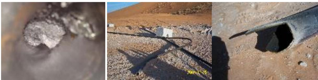
**Figure I.12** Conduite détruite suite à la formation d'un bouchon d'hydrate.
