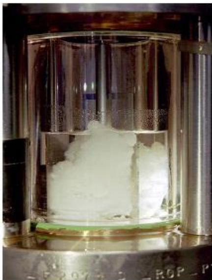
**Figure I.8** Photo de cristaux d'hydrate dans un réacteur agité.
