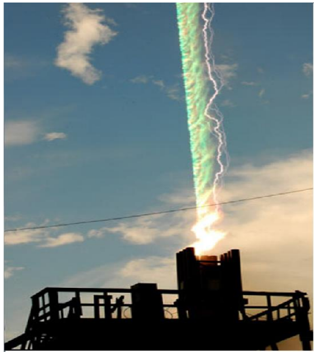
Figure 1.10 : Système de déclenchement artificiel de la foudre [19]
