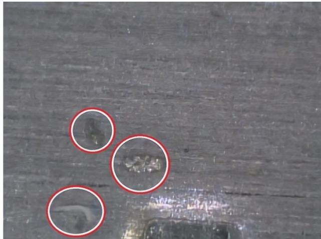
Figure I.10 : Cathode d'un condensateur après 500 cycles ( $\times 200$ ). [Per-03]
