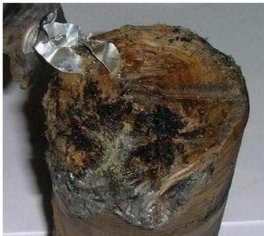
Figure I.7 : condensateur après explosion.
