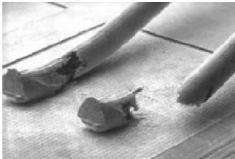
Figure I.19 Rupture d'un bonding d'émetteur due à la corrosion [Bou-10]
