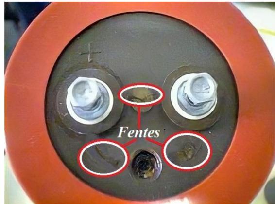
Figure I.6 : Fentes sur un condensateur
