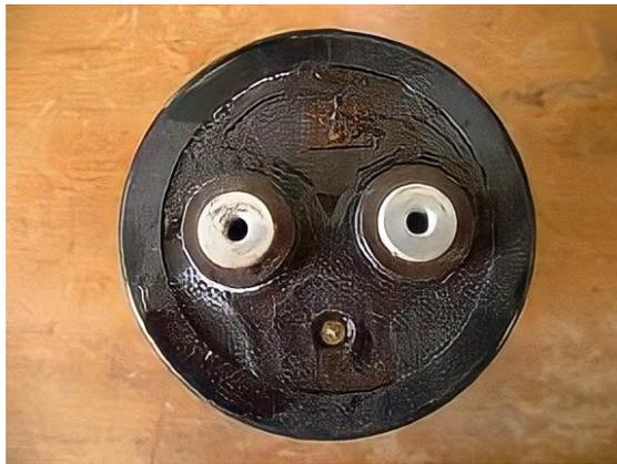
Figure I.5 : Fuite d'électrolyte sur un
