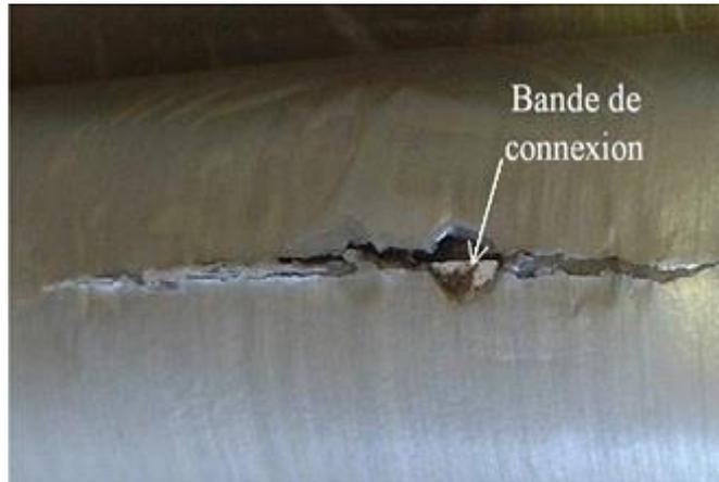
Figure I.9 : Destruction d'un condensateur [Per-03]
