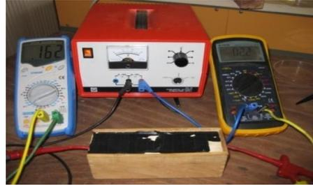
**Figures III.45:** montage utilise pour la caractérisation I(V)
