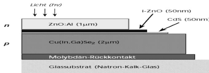
**Figure I.12:** Coupe de la cellule à base de  $\text{ZnO:Al}$ ,  $\text{ZnO}$ ,  $\text{CdS}$ ,  $\text{Cu(In,Ga)Se}_2$ ,  $\text{Mo}$ , verre [27].
