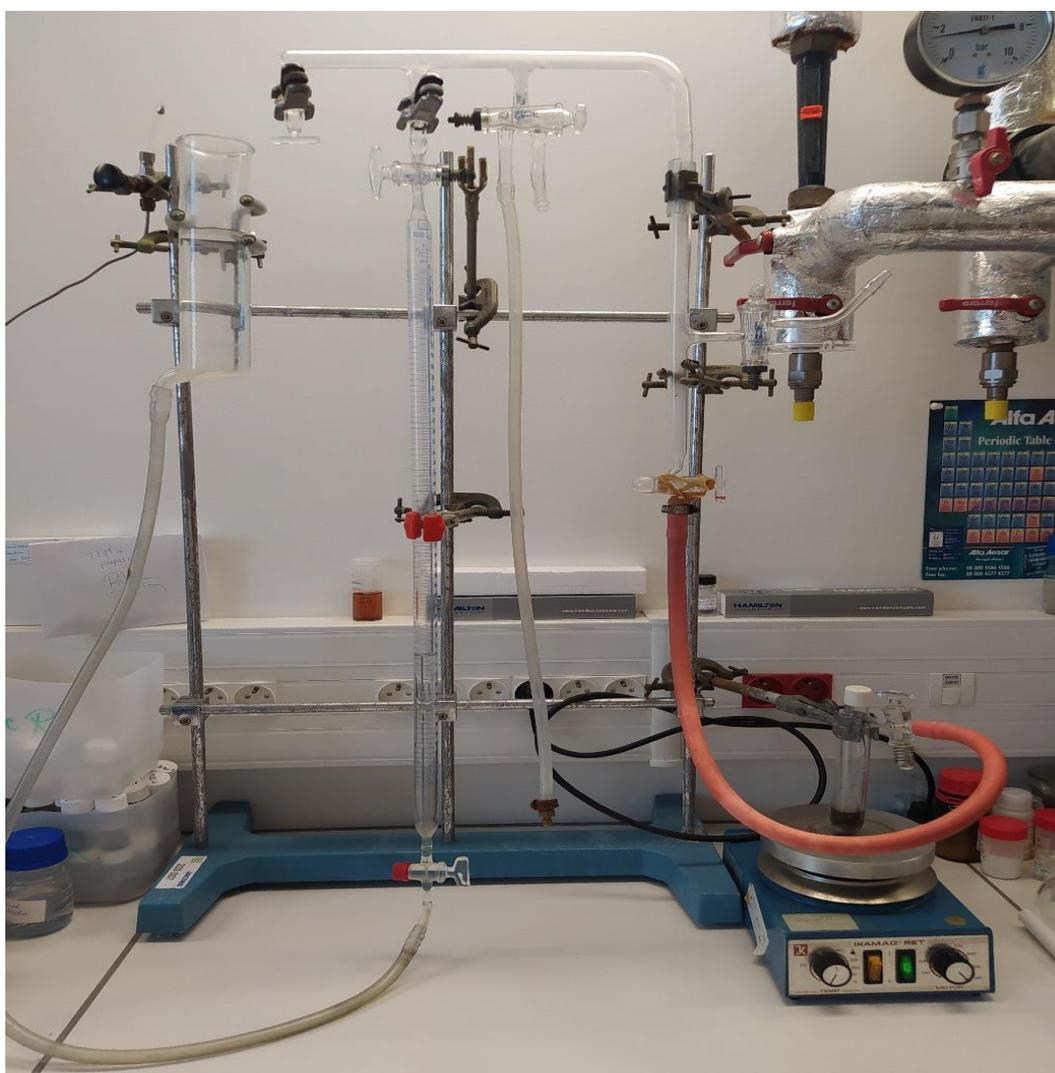
**Figure IV. 6 :** Photo de dispositif volumétrique utilisé pour la décomposition du Borazane
