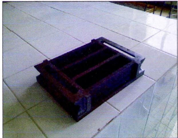
**Figure III-23 :** Moule à 3 alvéoles pour  $4 \times 4 \times 16 \text{ cm}^3$
