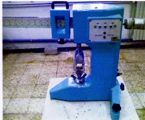
**Figure (III.24) :** Appareil CONTROLS pour l'essai de résistance à la flexion
