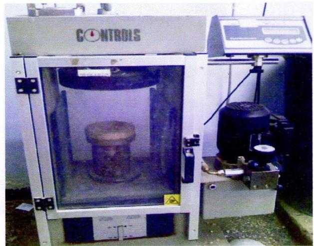
**Figure (III-25) :** Machine d'essais à la compression au laboratoire L.T.P.O
