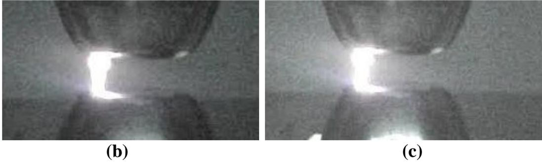
On a observé un canal entre les deux électrodes (claquage) voir **Figures (a)** à 37,5kv. La méthode de défragmentations des séquences vidéo nous a permet de voir l'évolution du volume du canal qui augmente coté de l'électrode mis sous haute tension jusqu'à l'électrode mis a la masse voir **Figures (c,d)**, nous avons observé des traces d'amorçage matérialisées par des impacts au centre et a l'extrémité des électrodes.
