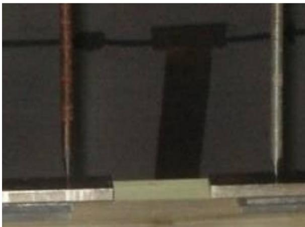
**Figure III.9 : barre - barre en air à plusieurs distances en tension alternative**
