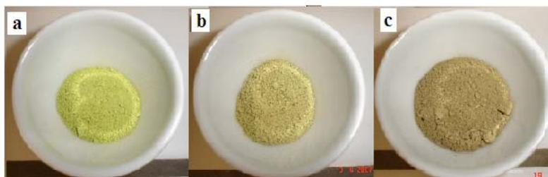
**Figure IV.6** : l'aspect des poudres du matériau  $\text{NiFeCO}_3$  après traitement hydrothermal : (a) traité à  $85, 100, 120^\circ\text{C}$  durant 1 à 15 jours ; à  $140^\circ\text{C}$  de 1 à 4 jours et à  $160$  et  $180^\circ\text{C}$  durant quelque heures ; (b) traité à  $140$  et  $160^\circ\text{C}$  de 4 à 7 jours ; (c) traité à  $160^\circ\text{C}$  durant 15 jours.
