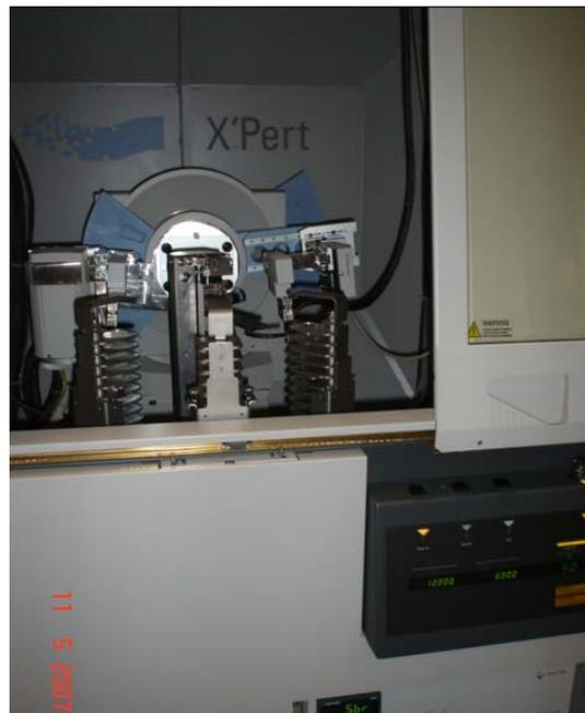
**Figure 11** : Appareil pour diffraction des rayons X aux bas angles
