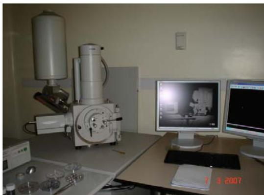
**Figure 15:** Appareil de microscopie électronique à balayage (MEB)
