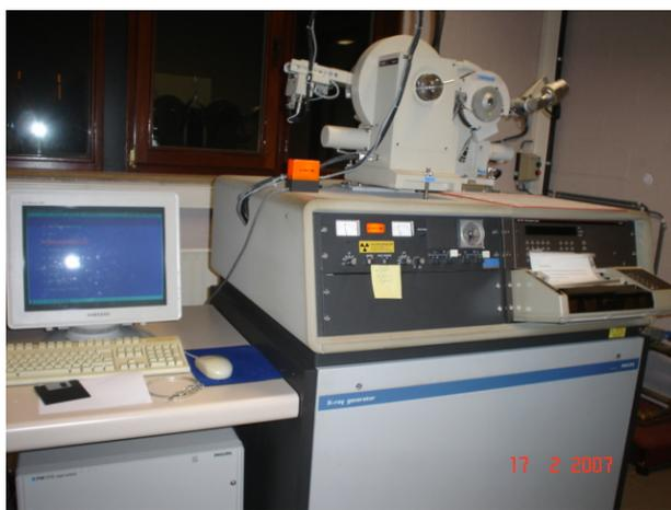
**Figure 7** : Appareil pour diffraction des rayons X aux hauts angles
