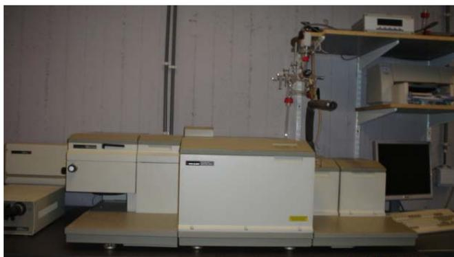
*Figure 19* : Appareil de spectroscopie FT-IR
