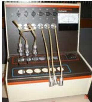
**Figure 3:** dispositif pour le dégazage des échantillons
