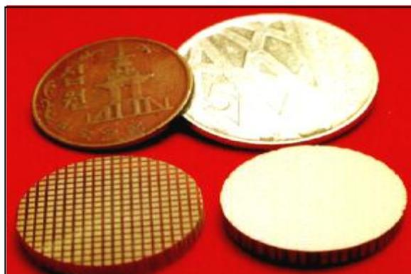
Fig. E.3 - Composites 1.3 fabriqués (sans métallisation à gauche) [2]
