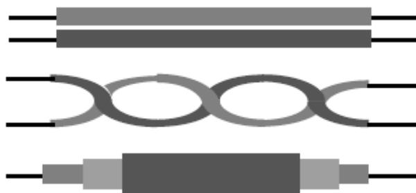
Fig.II.5 Les trois principaux type de câbles
