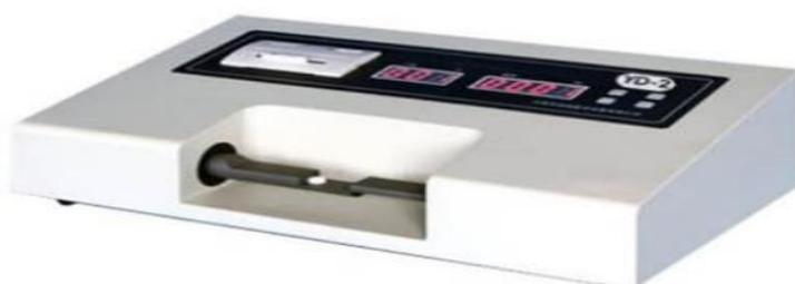
Pour chaque détermination, orientez-le comprimé de la même façon par rapport à la direction d'application de la force.
