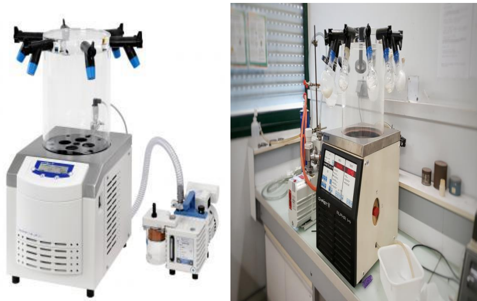
Fig.1 Lyophilisateur. La lyophilisation permet de retirer l'eau d'un produit liquide, pâteux ou solide, à l'aide de la surgélation puis d'une évaporation sous vide de la glace sans la faire fondre.
