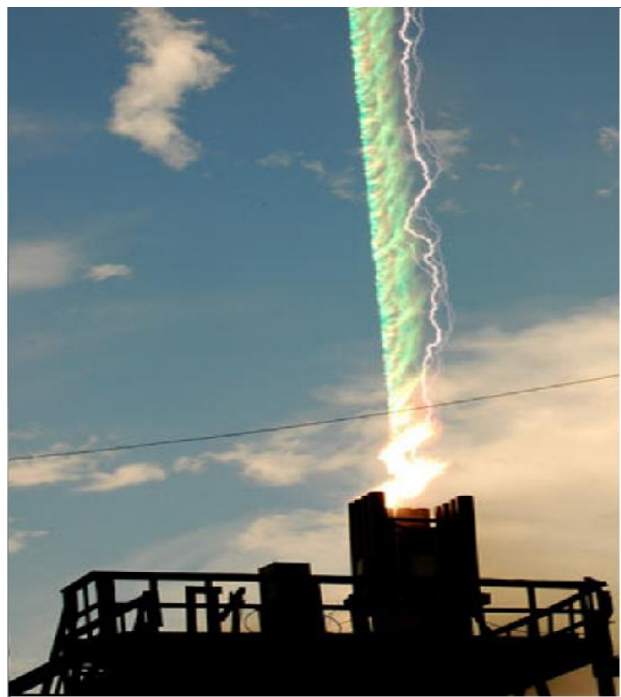
Figure 1.10 : Système de déclenchement artificiel de la foudre [19]
