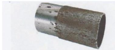
**Figures I.4** Pièces métallique présentant une corrosion par piqûres
