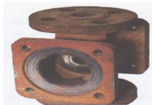
**Figure I.2** Corrosion généralisée affectant la surface d'une pièce métallique
