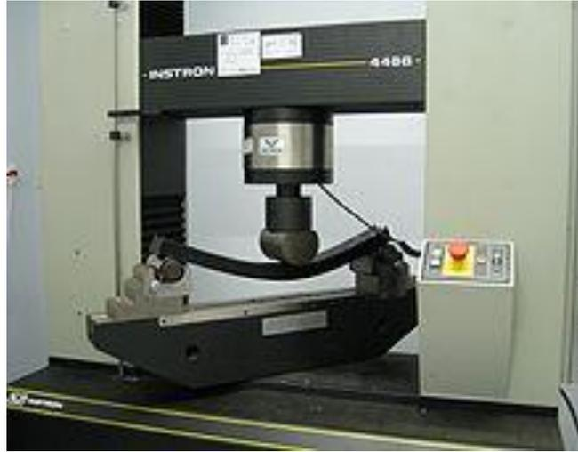
**Figure 6-III Machine pour essai de flexion 3 points.**
