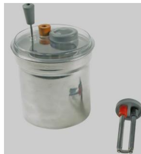
b) Un calorimètre (système isolé)
