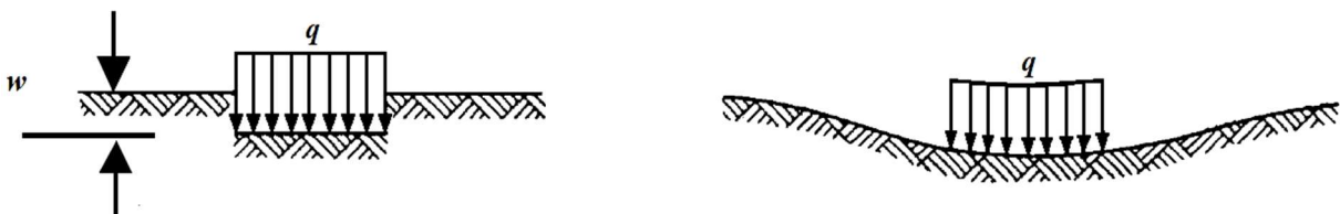
Fig.1.18. Déplacement d'une fondation élastique de type Winkler soumise à une charge répartie q .
