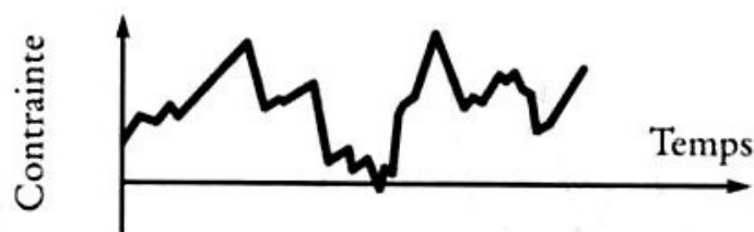
Fig.b. Chargement non périodique quelconque.
