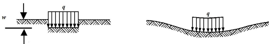
Fig.1.13. Déflexion d'une fondation élastique de type Winkler soumise à une charge répartie q .
