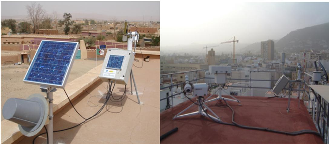
Fig. II. 18 : Des instruments des mesures de l'épaisseur optique d'aérosols AOT (Aerosol Optical Thickness) : à gauche Tamanrasset, Algérie, à droite : à Santa Cruz de Tenerife (Espagne), Observatoire sous l'intrusion subsaharienne en 3 Mars 2004.
