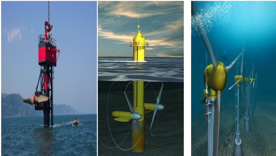
Figure 4.16 Turbines à courant marin.
