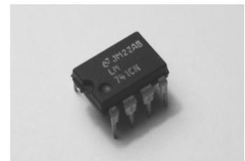
La présence d'un gain différentiel infini implique que la moindre différence de potentiel entre les deux entrées de l'amplificateur l'amènera à saturer. Si l'on ne désire pas que la tension de sortie de l'amplificateur soit uniquement limitée à  $\pm V_{\text{sat}}$  suivant le signe de la différence de potentiel entre les deux entrées de l'amplificateur, l'utilisation d'une contre-réaction négative est obligatoire.
