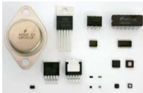
Physiquement, un amplificateur opérationnel est constitué de transistors, on le trouve communément sous la forme de circuit intégré.
