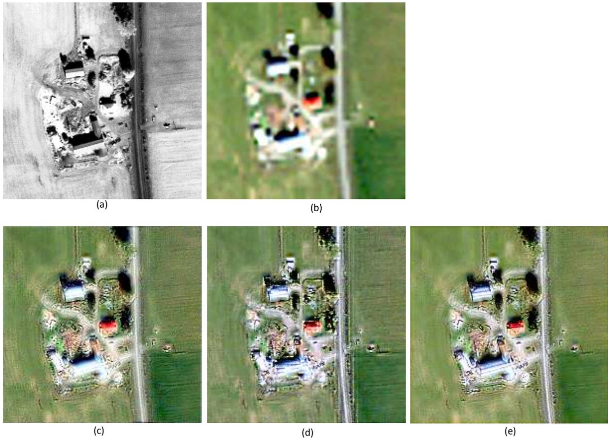
**Figure-III-16** Fusion d'une paire d'image Ikonos de dynamique de 11 bits : (a) image PAN, (b) composition RGB de l'image MS suréchantillonnée, (c) fusion par la méthode basée sur la TF [35], (d) fusion par la méthode WiSpeR [36], (e) fusion par la méthode proposée FUFSER.
