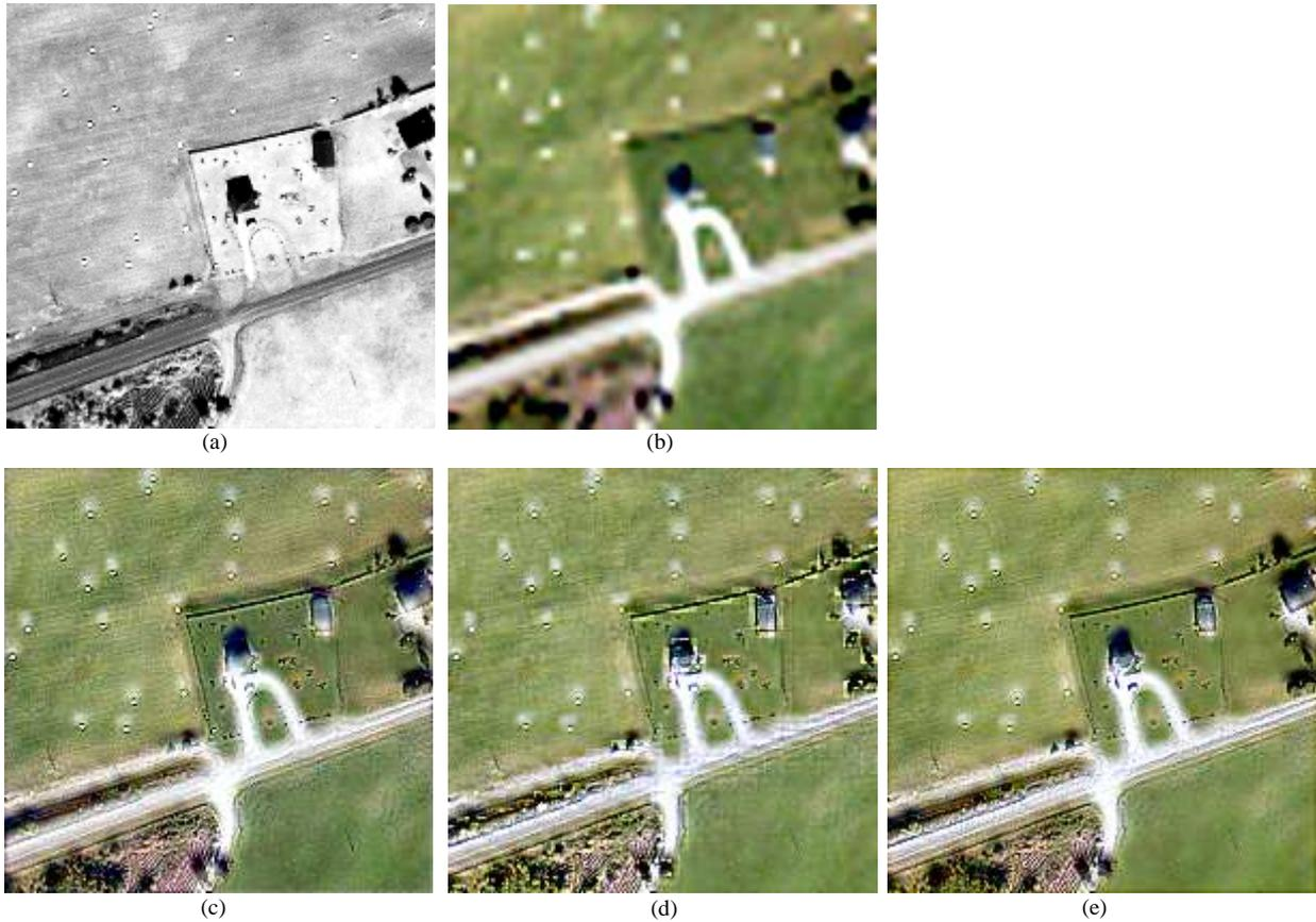
**Figure-III-17** Fusion d'une paire d'image Ikonos de dynamique de 11 bits : (a) image PAN, (b) composition RGB de l'image MS suréchantillonnée, (c) fusion par la méthode basée sur la TF [35], (d) fusion par la méthode WiSpeR [36], (e) fusion par la méthode proposée FUFSE.
