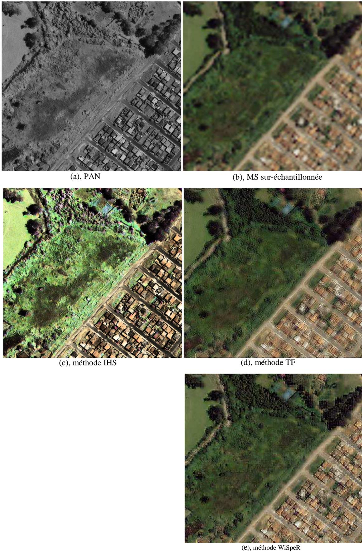
**Figure-II-3** Fusion d'images : (a) Image PAN, (b) Image MS sur-échantillonnée, (c) image fusionnée par IHS, (d) image fusionnée par la méthode utilisant la TF [35], (e) image fusionnée par la méthode WiSpeR [36].
