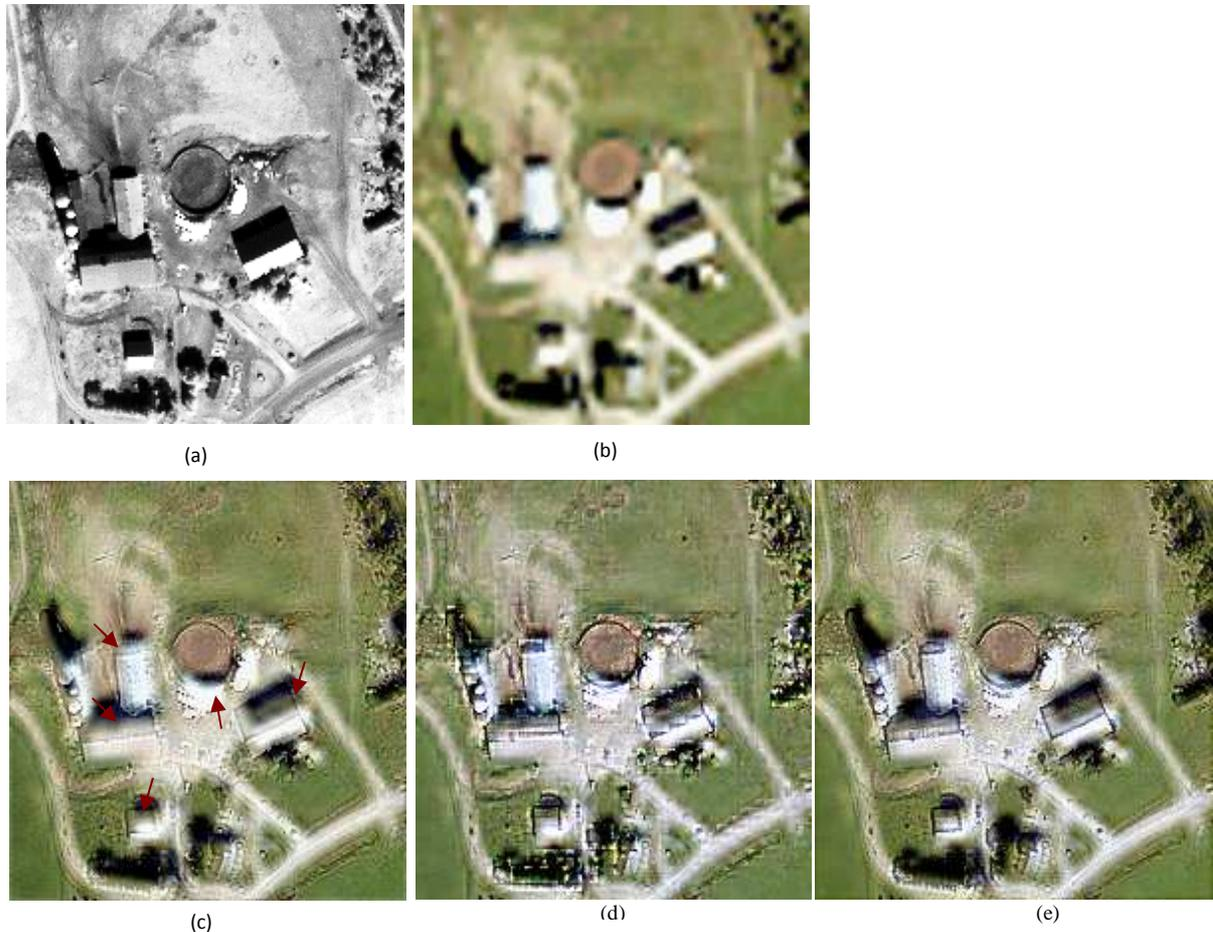
**Figure-III-15** Fusion d'une paire d'image Ikonos de dynamique de 11 bits : (a) image PAN, (b) composition RGB de l'image MS sur-échantillonnée, (c) fusion par la méthode basée sur la TF [35], (d) fusion par la méthode WiSpeR [36], (e) fusion par la méthode proposée FUFSER.
