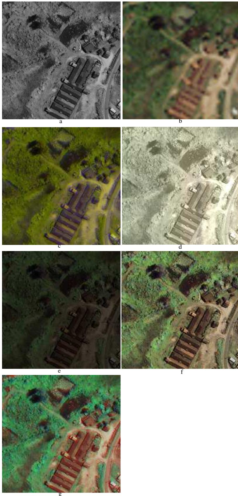
**Figure-II-2** Fusion d'images : (a) Image PAN, (b) Image MS sur-échantillonnée, (c) image fusionnée par IHS, (d) image fusionnée par PCA, (e) image fusionnée par la méthode de Brovey, (f) image fusionnée par la méthode CN, (g) image fusionnée par la méthode P+XS.
