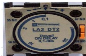
Bloc de Contact auxiliaires temporisés au travail 1NC (55-56), 1NO (67-68)
