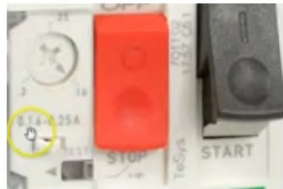
Exemple de plaque signalétique et calibre d'un disjoncteur moteur
