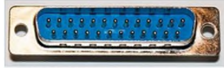
Connecteur mâle DB-25 pour RS-232
