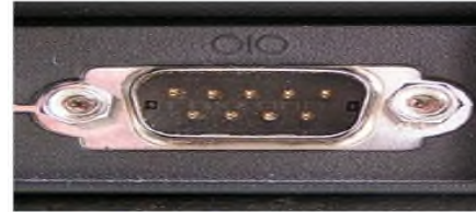
Un connecteur DE-9, improprement appelé DB-9, mâle utilisé comme port série sur un ordinateur personnel
