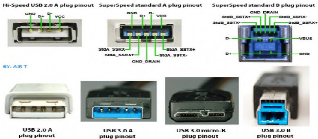
Connecteurs USB les plus courants en microinformatique et leur brochage
