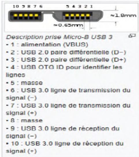
Brochages des connecteurs USB 3 : type-micro et type-A
