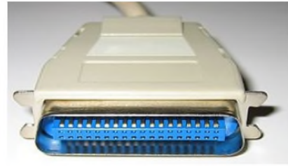
Connecteur Micro Ribbon à 36 pins
