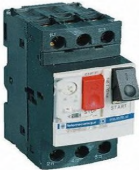
Disjoncteur-moteur magnétothermique (sectionneur+disjoncteur+relais thermique)
