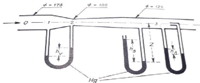
Il comporte un venturi, une prise de pression statique et une prise de pression double.
