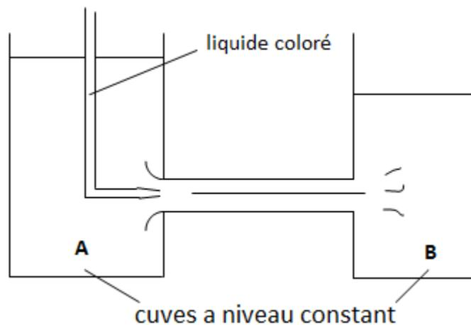
Lorsque le débit qui s'écoule à travers le tube est faible, le filet coloré est parfaitement rectiligne et parallèle à l'axe du tube. L'écoulement paraît indépendant du temps ; il s'établit sous forme de lignes parallèles. On dit qu'il est *laminaire* (1).
