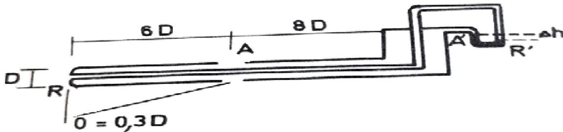
Ses caractéristiques dimensionnelles doivent respecter les rapports indiqués sur la figure précédente, afin de garantir une mesure correcte ; lors des mesures, il faut orienter l'appareil dans l'écoulement de façon à ne pas y produire de perturbations.
