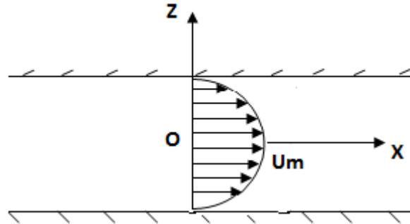
Figure Répartition des vitesses dans la conduite.
