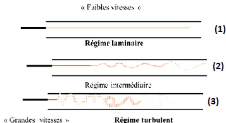
Figure. Différents types d'écoulements
